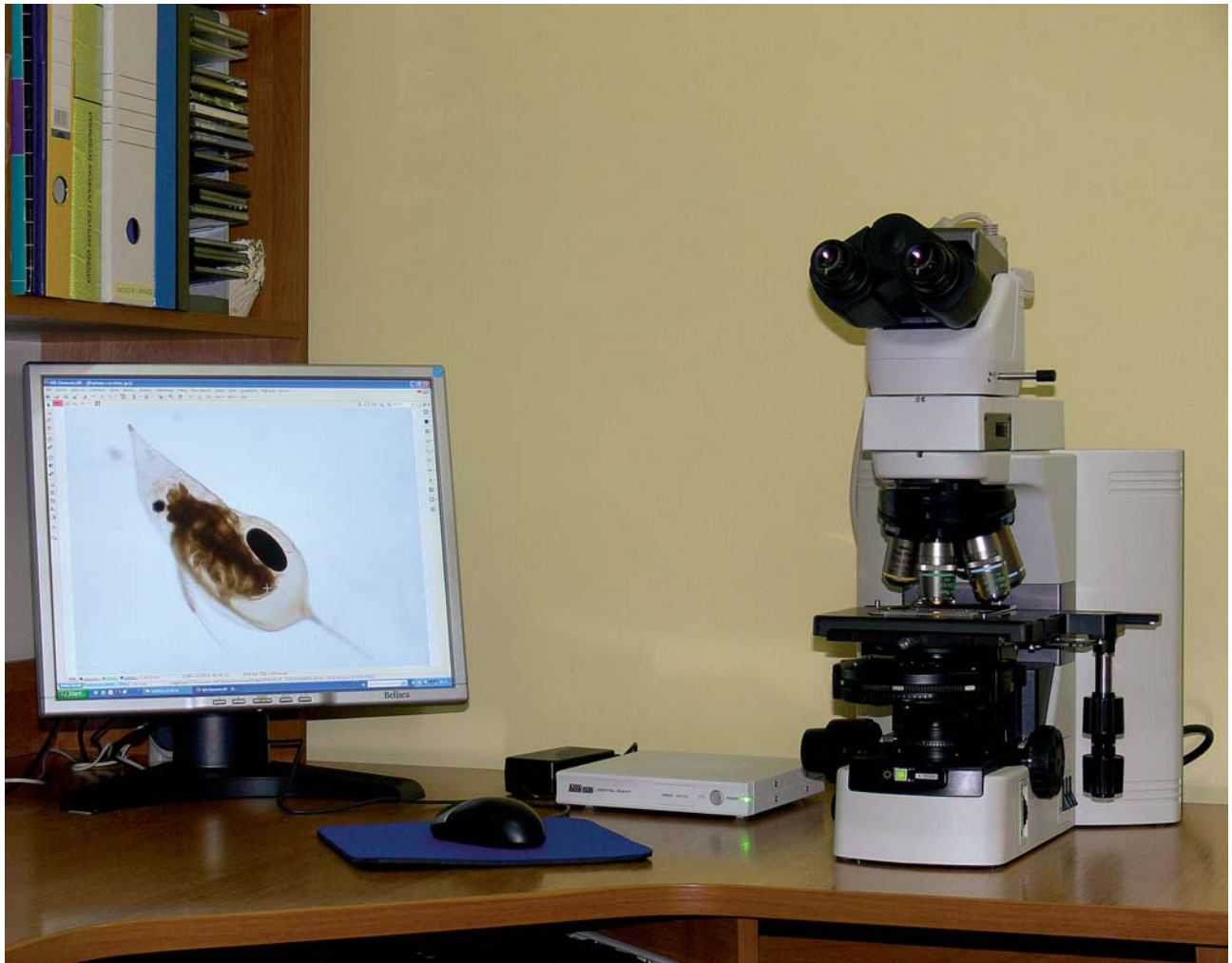
Mikroskop optyczny wykorzystywany do badań biologicznych elementów jakości wód (fot. Sławomir Rubacha)
