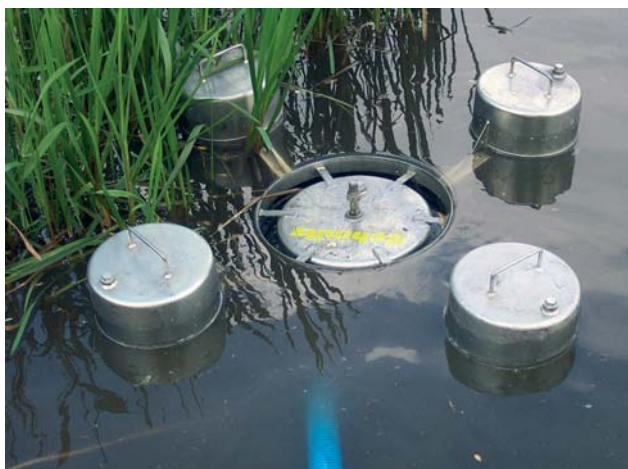
Urządzenie do likwidacji zanieczyszczeń powierzchniowych – zbieracz oleju (fot. archiwum WIOŚ Zielona Góra)
